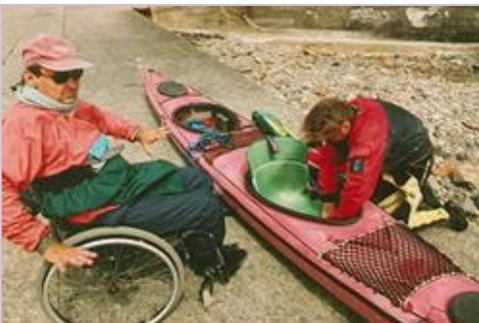
Des aides peuvent être apportées par des calages complémentaires à ceux proposés d'origine par les constructeurs (coques hautes, gouttières en mousse, calages dorsaux ou latéraux adaptés...). Il existe plusieurs modèles de coques sur le marché, réalisées à l'unité en fonction des besoins des pratiquants (Ex : pour une personne amputée de la jambe gauche, lester le côté gauche du kayak afin d'éviter que l'embarcation ne gite en permanence).
