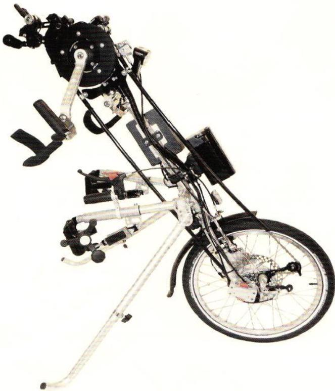
Sur le stand de Marconnet technologie, cet étonnant vélo adapté d'origine allemande a éveillé ma curiosité. Conçu spécialement pour les personnes tétraplégiques, l'ElectroDrive Lipo Smart Tétra est un handbike doté d'une assistance électrique offrant de nouvelles perspectives de déplacement.
