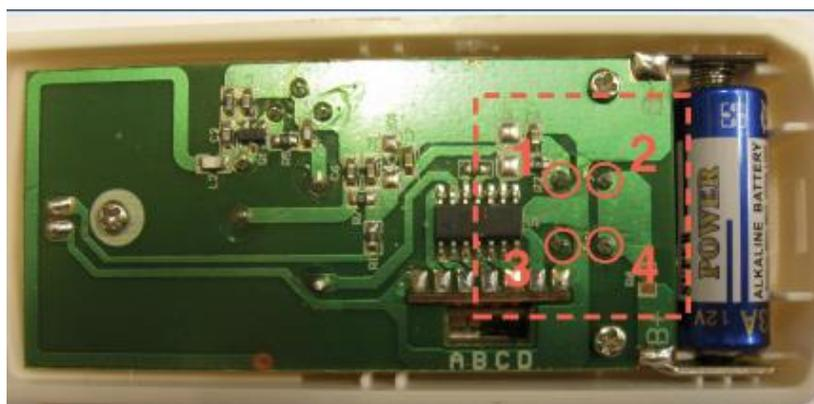
③ Avant de commencer la soudure il faut faire un trou dans la coque du bouton pour y faire passer le câble. Choisissez un endroit adéquat (en général sur le côté du bouton) et faites un trou le plus petit possible afin que le câble soit bien maintenu (pour ne pas tirer sur la soudure). →
